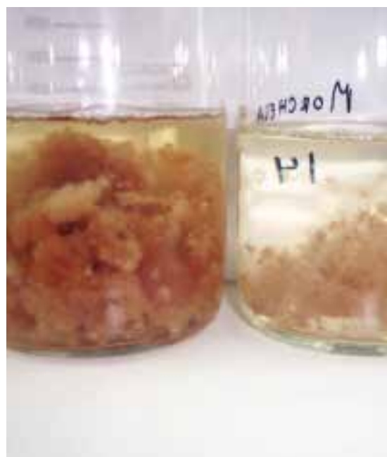
Foto 37. Utilización de botellas y agitador orbital para producción a menor escala de micelio de hongos ectomicorrícicos (izquierda). Micelio de Morchella multiplicándose en botella en medio líquido (derecha).
