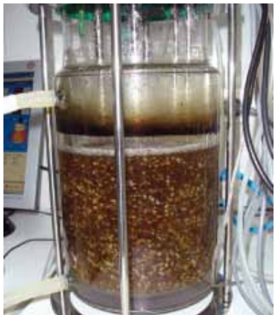
Foto 36. Utilización de biofermentador para una mayor producción micelial de hongos ectomicorrícicos (izquierda). Aspecto del crecimiento de micelio en vaso de 7 litros en condiciones controladas (derecha).
