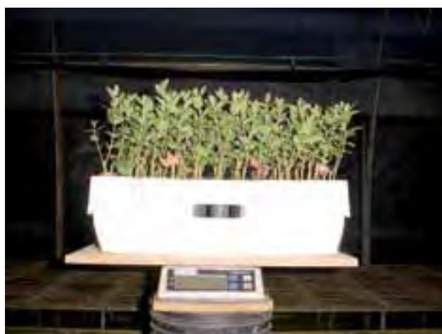
Figura 4. Balanza de plataforma para la determinación del contenido de humedad de las plantas cultivadas en bandejas.
