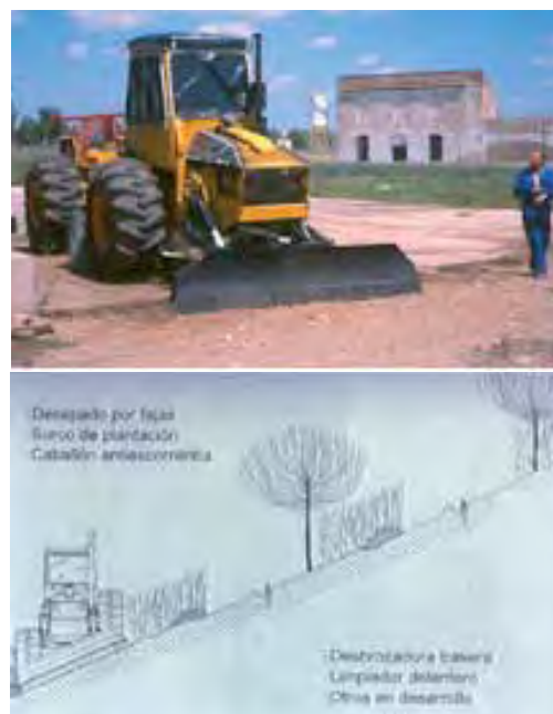
Figura 7. Tractor de alta estabilidad (arriba) y esquema mostrando como trabaja en suelos con mucha pendiente (abajo).
