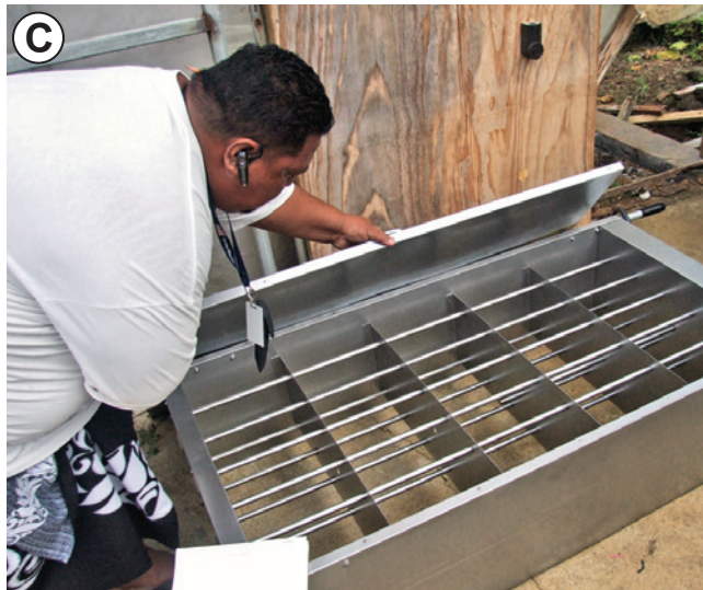
Figura 6.11 —Para los viveros que elaboran sus propios sustratos, la pasteurización mediante el vapor (A) o calor de leña (B) es simple, eficaz y se puede lograr con un equipo portátil. Los esterilizadores eléctricos de tierra pueden calentar la tierra durante el tiempo suficiente para eliminar la mayoría de las semillas de malezas y patógenos (C). Fotos A y B de Thomas D. Landis y foto C de J.B. Friday.
