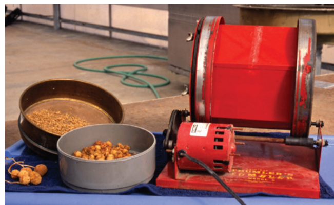
Figura 9.4 —Se pueden usar los tambores para rocas de tamaño de aficionados para escarificar las semillas y evitar su destrucción, lo cual puede ocurrir en la escarificación con ácido sulfúrico o por calor. Foto de Tara Luna.
