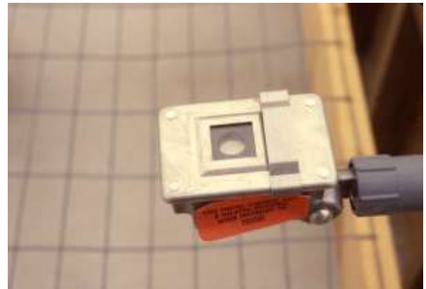
Figura 3.3.38 Las fotoceldas detectan cambios en la intensidad de la luz, y por tanto, pueden ser usadas para controlar los sistemas de alumbrado en invernaderos.
