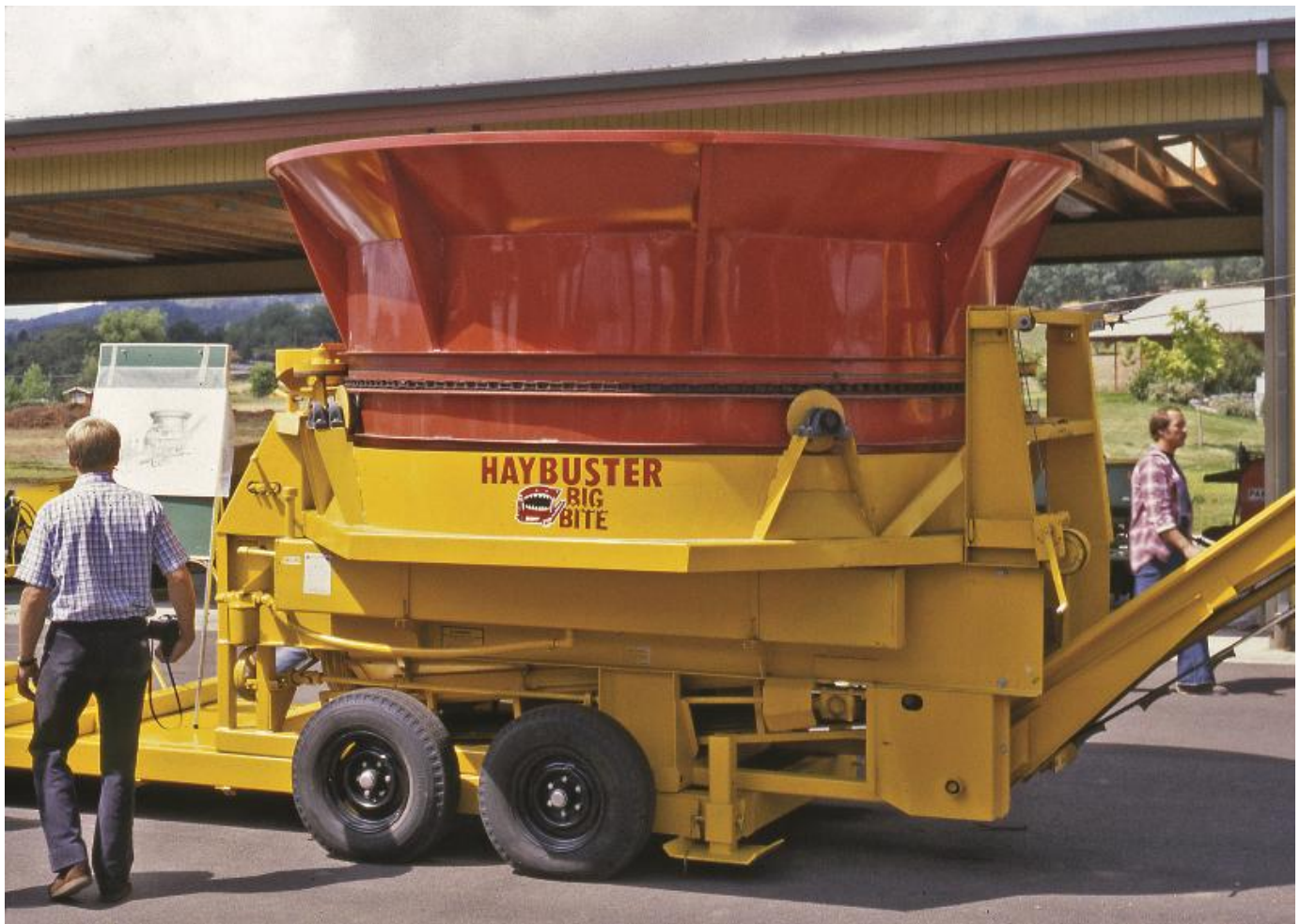
Figura 7.3.14 Las plantas de desecho pueden ser procesadas en una tina moledora y compostadas
