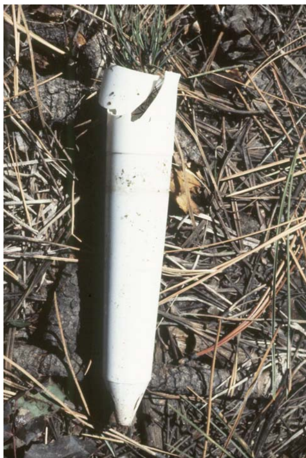
Figura 2.1.12 La luz solar intensa, especialmente la radiación ultravioleta, puede originar quebraduras en los contenedores de plástico. Actualmente muchos contenedores de plástico están contruidos con productos químicos “inhibidores de la radiación ultravioleta.”
